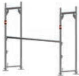
Vertikalrahmen aufstecken und mit Geländerholm sichern
